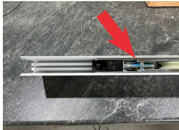
Den Laufwagen von oben in den Schraubkanal des Flügelprofils legen, mit der Justierschraube nach außen zeigend. Dies ist wichtig, um ein nachträgliches Einstellen der Anlagen zu ermöglichen! Den Laufwagen mit den Linsenkopfschrauben (4,2x19 mm) in einem Abstand von 60 mm vom Rand herein anschrauben.
